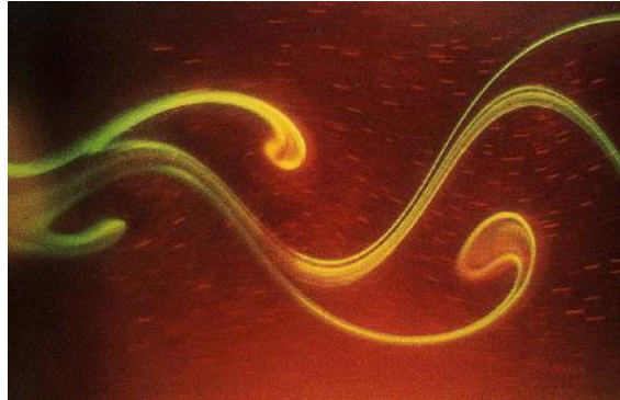
FIGURE 2.4 – Écoulement instationnaire dans le sillage d'un cylindre (non visible, à gauche du cadre de la photo). Visualisation simultanée des lignes d'émission créées par injection de colorant sur le cylindre et de trajectoires de particules en suspension. Ces dernières révèlent la direction instantanée du vecteur vitesse. Cliché PMMH.
