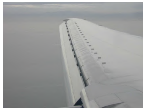
FIGURE 9.8 – Schéma d'un profil d'aile avec bec de bord d'attaque et volets de bord de fuite. Document NASA. A droite, volet de bord de fuite et générateurs de turbulence sur une aile de Boeing 767.
