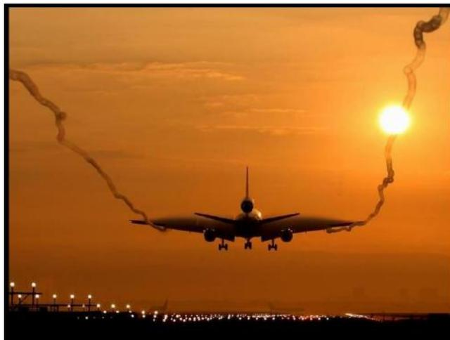
*Tourbillons marginaux (vortex) ; au soleil couchant, noter les deux tourbillons des volets et la répartition elliptique de la portance matérialisée par la condensation de l'humidité de l'air.*
