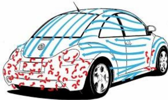
*Décollement aérodynamique sur une VW Beetle : le test aux fils de laine montre des décollements qui n'interviennent qu'au niveau du pare choc arrière de l'auto. Ceci est certainement dû à la dépression engendrée par les puissants tourbillons marginaux dus à la cambrure importante du toit. Ce que l'on gagne en traînée de pression et en partie perdu en traînée induite par la portance.*
