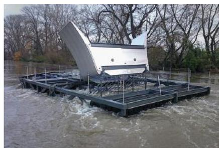
FIGURE 3 – L'hydrolienne d'Orléans, avec sa mécanique relevée au-dessus de la barge. On remarque les déflecteurs chargés d'écartier les gros débris charriés par le fleuve. © Hydroquest
