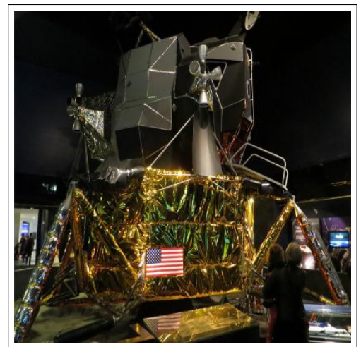
FIGURE 10 – Module lunaire des missions Apollo. Par endroits, l'épaisseur de la coque du module ne dépassait pas 2mm.
