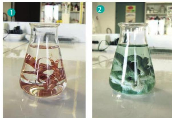
FIGURE 3 – Faire des trous dans l'aluminium avec des ions  $\text{Cu}^{2+}$
