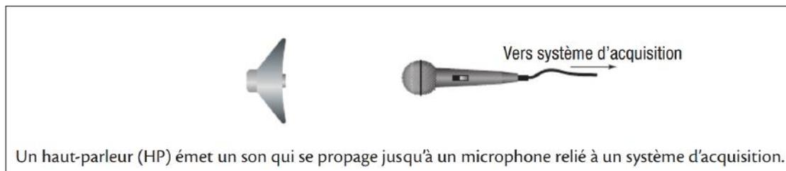
1. À partir de la figure ci-dessus, du matériel mis à disposition sur la table et de la notice d'utilisation de Latis Pro (<http://acver.fr/ltn>), **élaborer** un protocole expérimentale afin de mesurer la vitesse du son.
