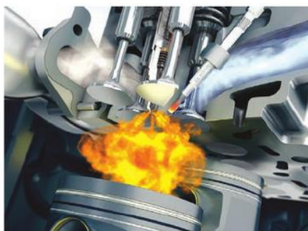
▲ Moteur à combustion interne Il est conçu pour transformer une énergie thermique en énergie mécanique. Cette énergie mécanique peut être transformée en électricité pour l'habitat grâce aux groupes électrogènes.
