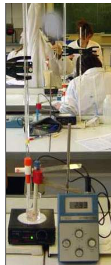
Dispositif pour le titrage pH-métrique
