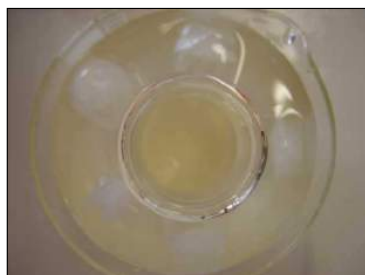
Filtrat placé dans un erlemeyer, le tout dans un bain d'eau glacée
