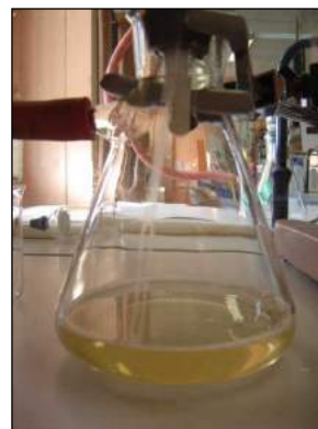
Après seconde filtration sur filtre büchner
