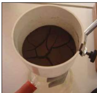
Le solide marron de dioxyde de manganèse reste sur le papier filtre.
