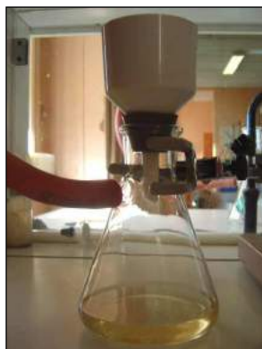
Filtration du mélange réactionnel sur filtre büchner
